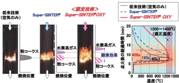
焼結層内の温度履歴の改善メカニズム
