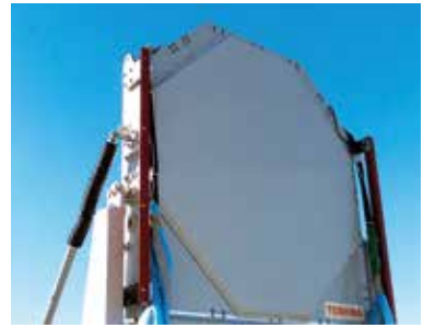
認定製品 マルチパラメータ・フェーズドアレイ気象レーダー W4498 (C)
